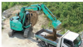
インターネットに接続した環境であればどこからでも遠隔操作可能に。 左は遠隔操作でダンプトラックに土砂を積んでいる様子。
