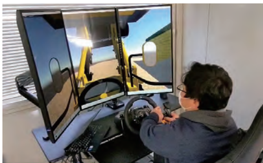
図3-2 デジタルツインで建機を遠隔操作
